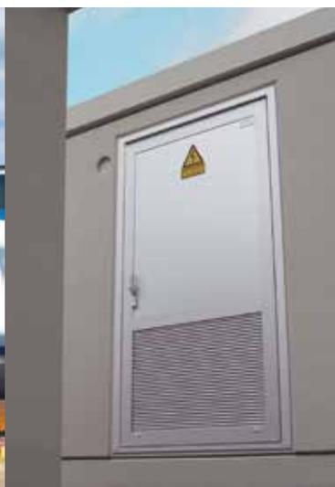
Ganz links: Türen und Lüftungsgitter aus Stahl: zum Korrosionsschutz verzinkt (Sendzimirverfahren), anschließend mit Standardfarbton RAL pulverbeschichtet.
