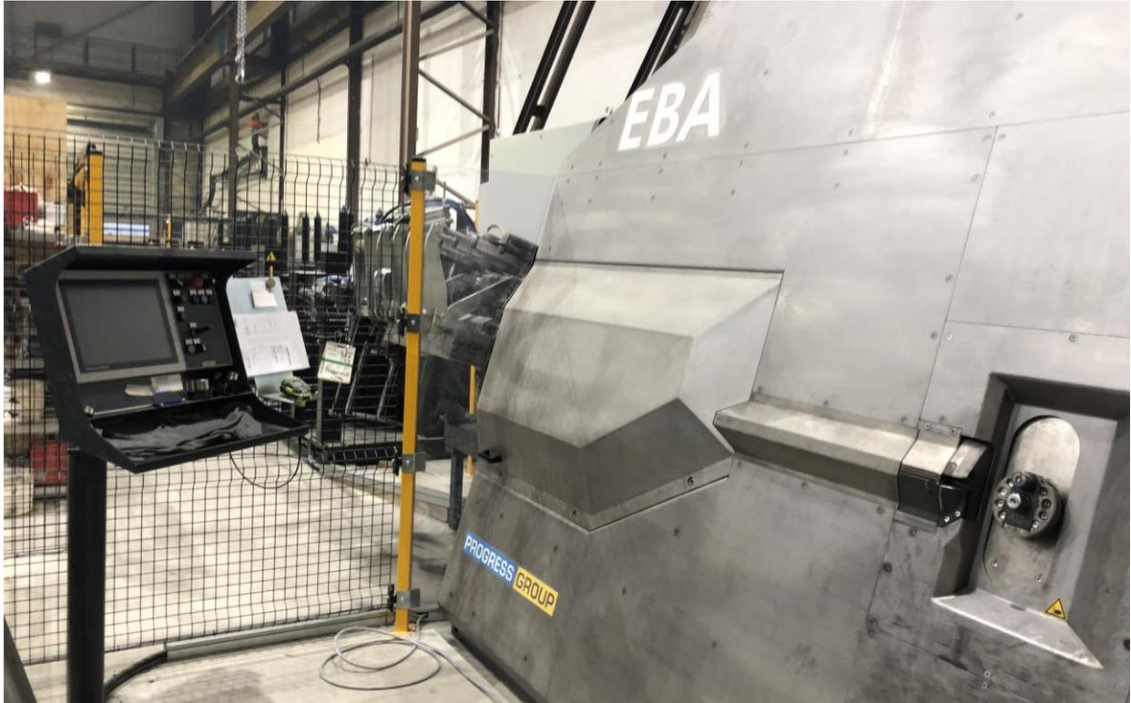
Die erste von drei neuen Maschinen für die Eigenfertigung von Bewehrungskörben ist im Werk Hoyerswerda bereits im Einsatz: die moderne Progress Biegemaschine EBA 16 ARW.
